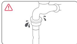
Schließen Sie die Maschine mit einem neuen Wasserzulaufschlauch an den Wasserhahn an und tauschen Sie einen undichten oder beschädigten Schlauch rechtzeitig aus.
